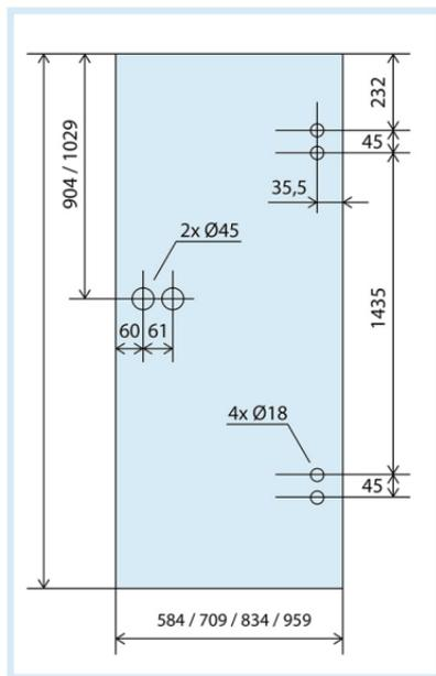
**Hinweis:** Die Abbildung zeigt ein Glastürblatt bei Verwendung von Standard-Zargen nach DIN 18101
